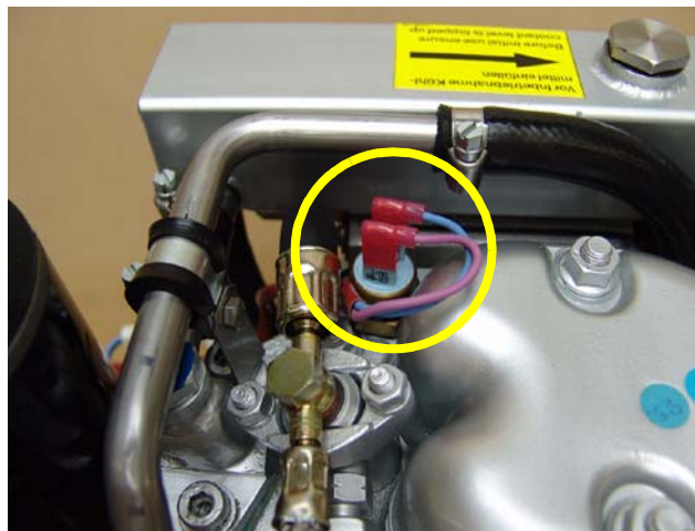
Fig. A.1-1: Commutateur thermique à la tête du cylindre
