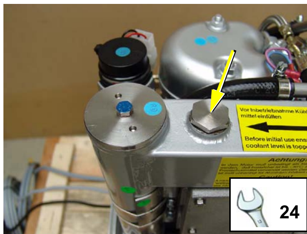
Fig. D.4.3-1: Le couvercle au-dessus du carter coude d'échappement refroidi à l'eau
