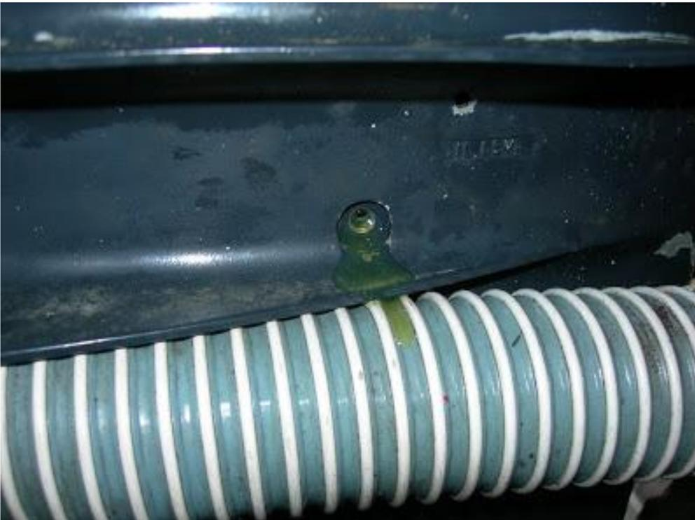
Vous trouverez l'huile d'embase en tube, dont il suffit de couper l'embout et vous roulez le tube sur lui-même, comme un tube de dentifrice. Vous pouvez la trouver en petit bidon plastique, avec embout pour l'embase et après il suffit de presser sur le bidon. Une fois que l'huile sort par le haut, vous remettez d'abord le bouchon de niveau en maintenant le flacon en bas. Ça permet de maintenir un peu l'huile quand vous mettez le bouchon du bas.
