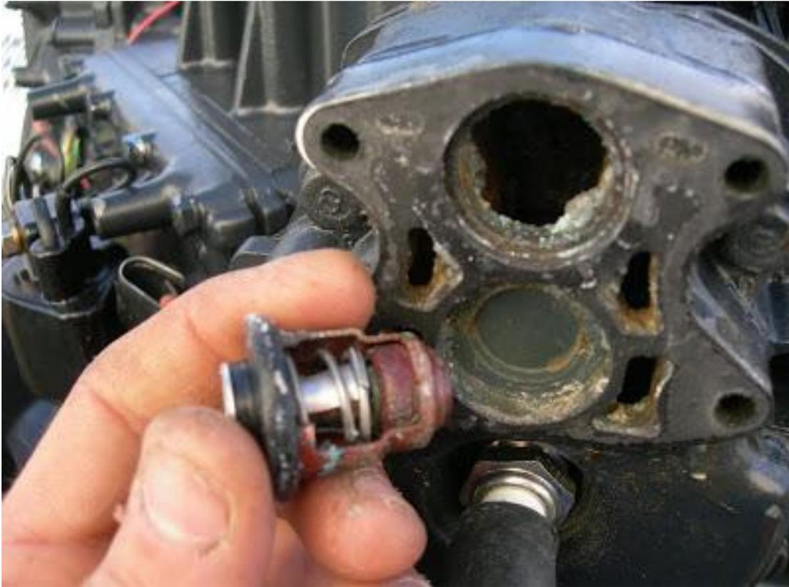
Vous pouvez remonter le calorstat s'il est bon autrement on le change. Maintenant démontez les bougies et avec une burette d'huile pour moteur 4 temps, mettez 4 ou 5 giclées dans les cylindres pour les lubrifier.
