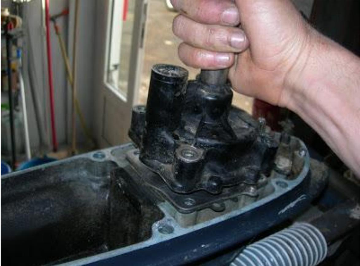
Avant de remettre les boulons il faut leur appliquer de la graisse, c'est la base en mécanique marine on met de la graisse sur tous les boulons que l'on remonte. Si vous ne faites pas ça, le sel finira par s'insinuer dans le filet et risque de souder les boulons à leur support.
