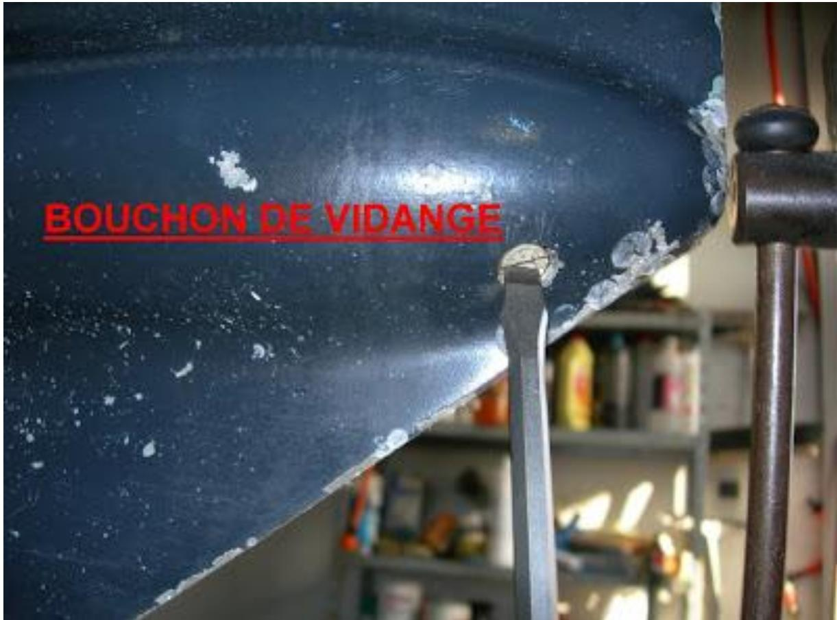
On dévisse le bouchon de vidange qui est placé sous le bulbe, puis le bouchon de niveau qui est au-dessus, en ayant bien sûr mis un bac pour récupérer l'huile usagée.
