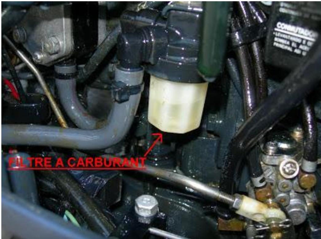
Sur un moteur 2 temps il vous faut vidanger les carburateurs, si vous ne le faites pas l'essence va s'évaporer et l'huile risque d'encrasser les gicleurs. Vous avez une vis sous les carburateurs, qu'il suffit de dévisser un peu pour laisser s'écouler le carburant.
