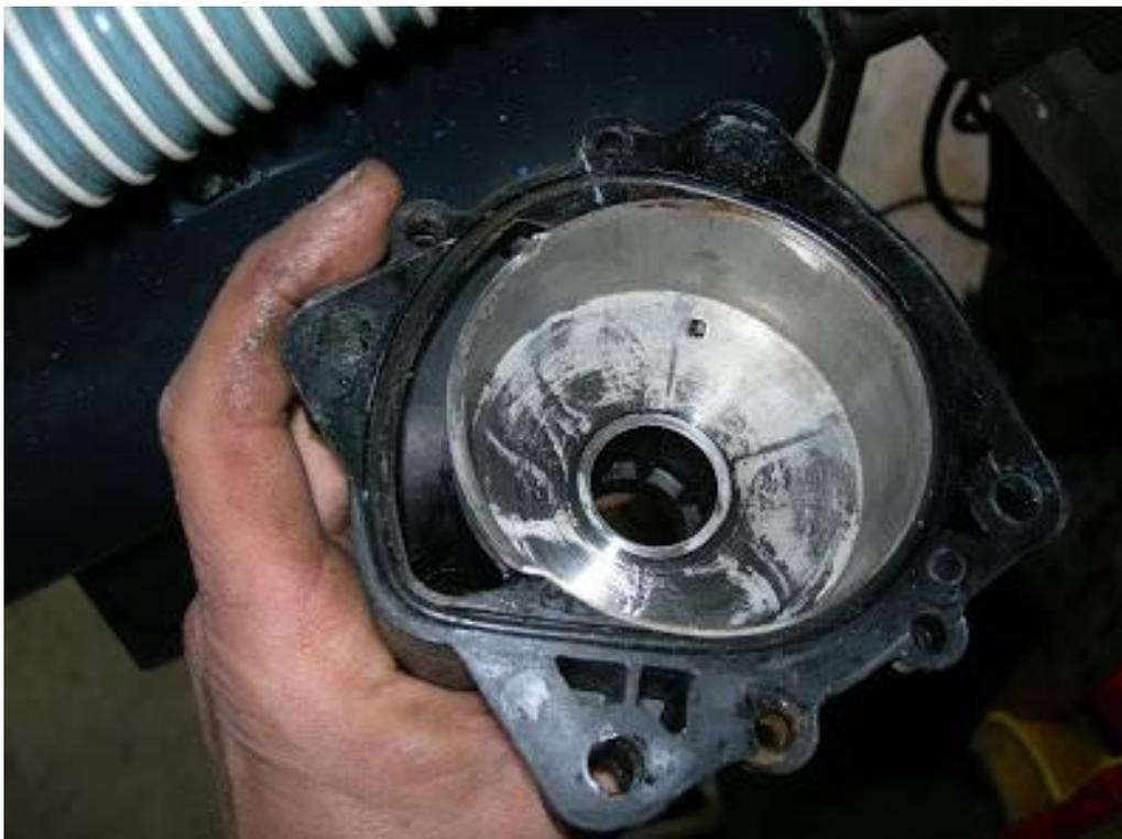
Il est sale, mais pas abimé, donc nettoyage et l'on peut remonter. On enduit le corps de pompe avec de la graisse silicone ou de la vaseline avant de remonter. Pour remonter le corps et faire rentrer la turbine, on prend l'arbre moteur avec la main et on le fait tourner dans le sens des aiguilles d'une montre. On pousse sur le corps de pompe et la turbine rentre dans son logement.
