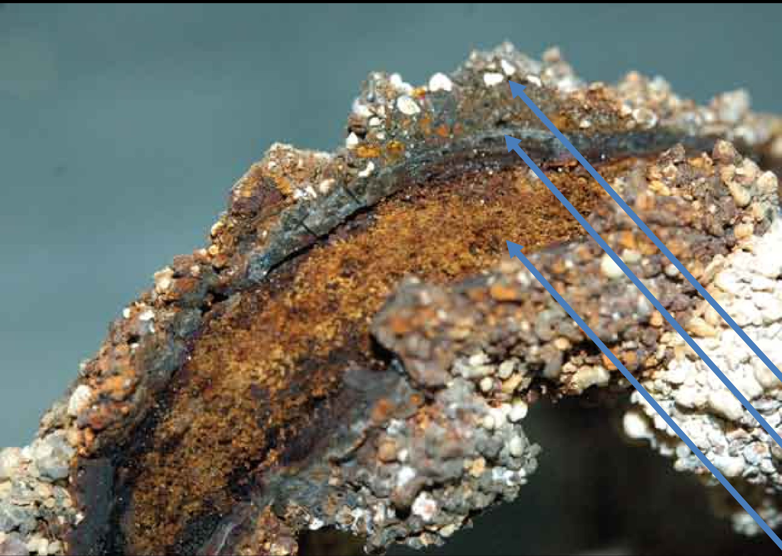
Stratigraphie des produits de corrosion du fer © Jacques Rebière
