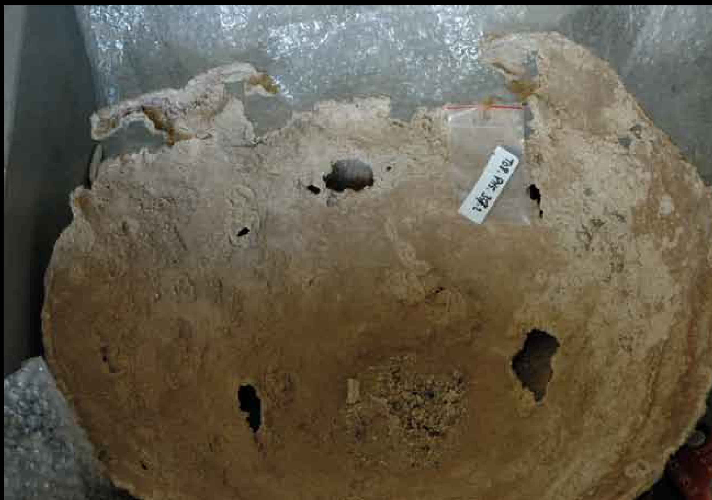
Bol corrodé © Jacques Rebière Objet victime d'une corrosion « incrustante » des carbonates de plomb qui perfore la matière métallique, la déforme et provoque des lacunes (cas de certains récipients volumineux).
