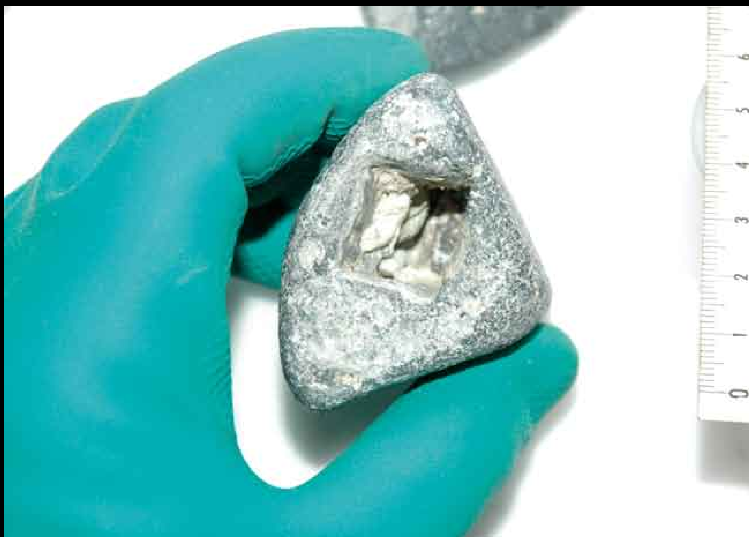
Quart de boulet © Jacques Rebière Les carbonates de plomb occupent des cavités d'objets et peuvent nuire à l'étude de toutes les parties des objets (cas des quarts de boulets).
