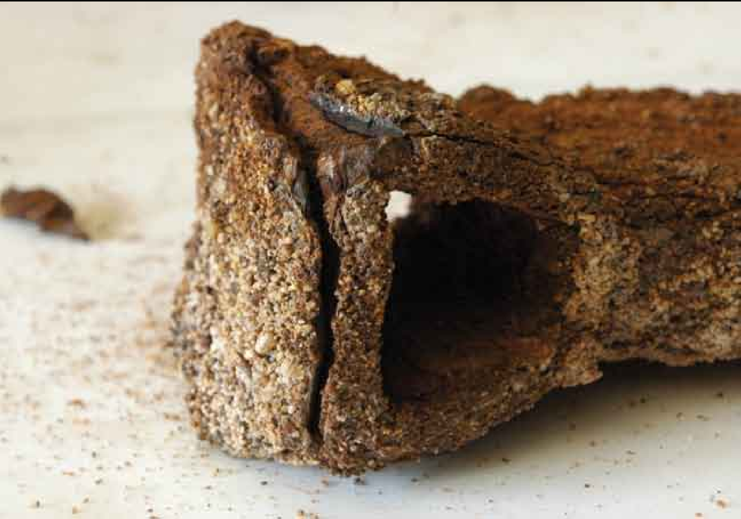
Fissures parallèles au noyau métallique, caractéristiques d'une corrosion active © Jacques Rebière
