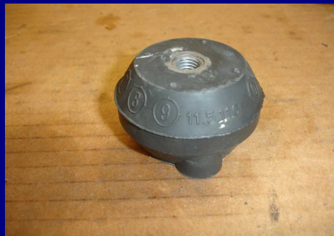
Autre variante en 60 shore et fixation 3 points
