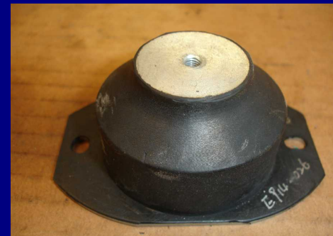
45 Shore et fixation en 2 points, peut également être utilisé pour un groupe électrogène
