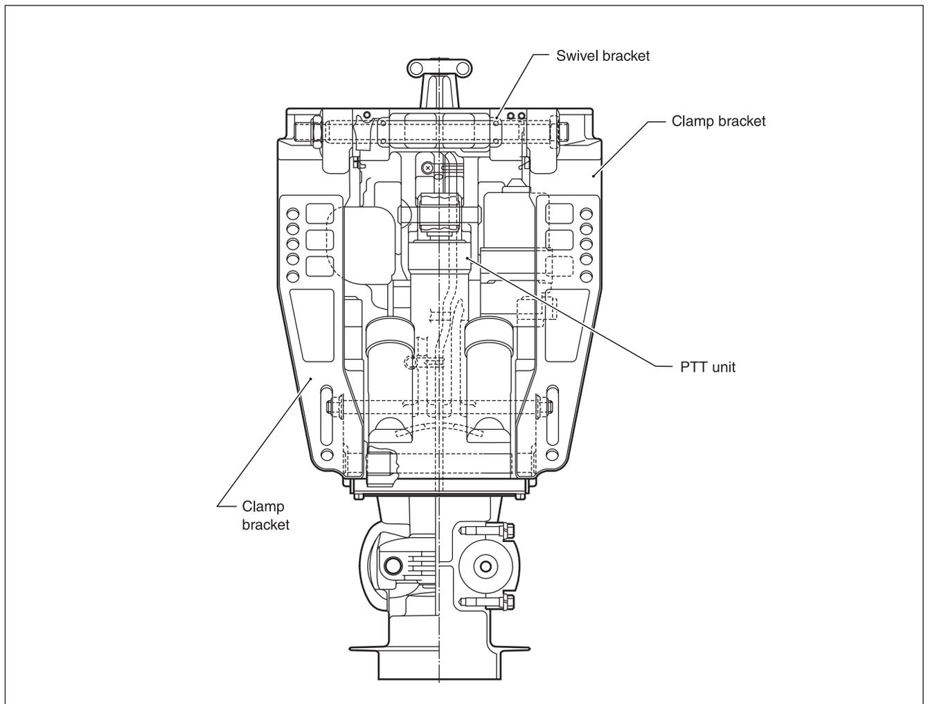
**CLAMP BRACKET / SWIVEL BRACKET / STEERING BRACKET**
