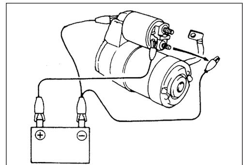
**PLUNGER AND PINION RETURN TEST**
