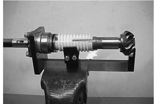
**REVERSE GEAR BACK-UP SHIM ADJUSTMENT**
