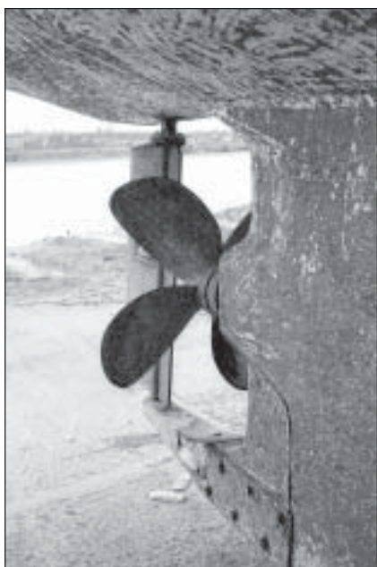
Photo 9 Bon profilage à l'avant de l'hélice
