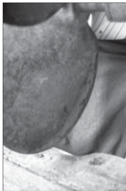
Photo 1 Début d'érosion provenant de la cavitation près du bord d'attaque sur la face antérieure de la pale
