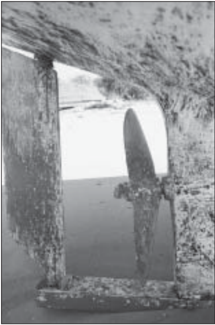
Photo 3 Dégagement insuffisant entre massif et hélice
