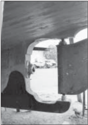
Photo 2 Garnir la cage d'hélice avec des pièces de forme, particulièrement à l'avant de l'hélice, réduit le rendement et augmente les vibrations
