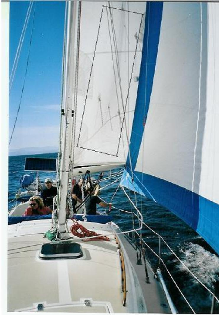
L'équipier borde la le génois au maximum, coupant ainsi le courant d'air entre les deux voiles
