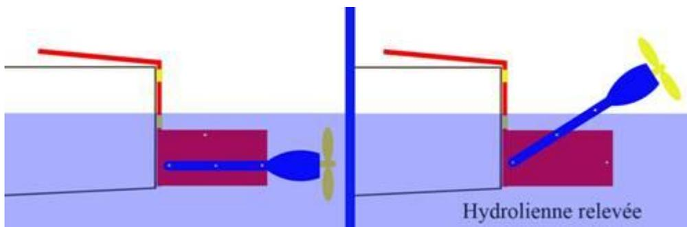
Cette hydrolienne recharge une batterie, et permet au voilier de fabriquer son électricité.
