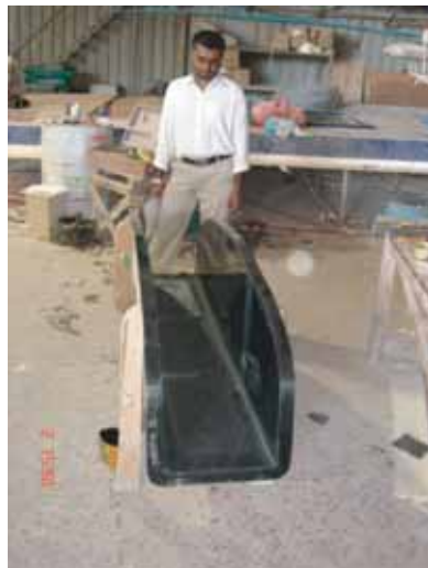
Moule fini du banc de nage central. Chaque partie (parties structurelles et autres éléments) du bateau doit avoir son propre moule.
