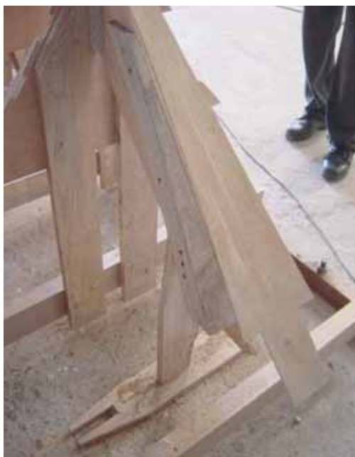
FIGURE 46 Photo montrant quelques détails de l'étrave
