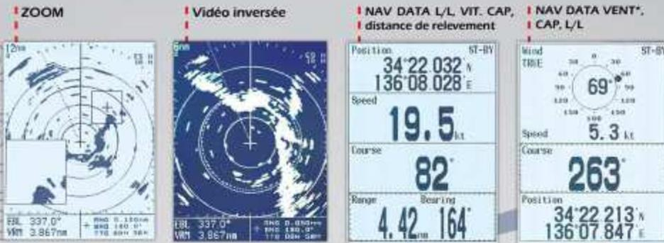
■ Le radar M1623 est doté d'un afficheur LCD à fort contraste, conçu pour les bateaux de plaisance et les petits navires de pêche. L'image est présentée en quatre niveaux de gris sur un écran 6". La représentation de la côte et des échos est améliorée grâce à l'utilisation de largeurs d'impulsions très fines et une double bande passante. L'écran est conçu pour un montage en extérieur.
