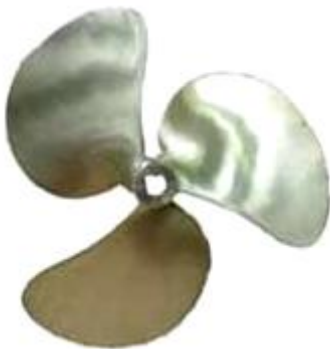
: Hélice tripales S = 73 % Skew (Photo : TechBoat)
