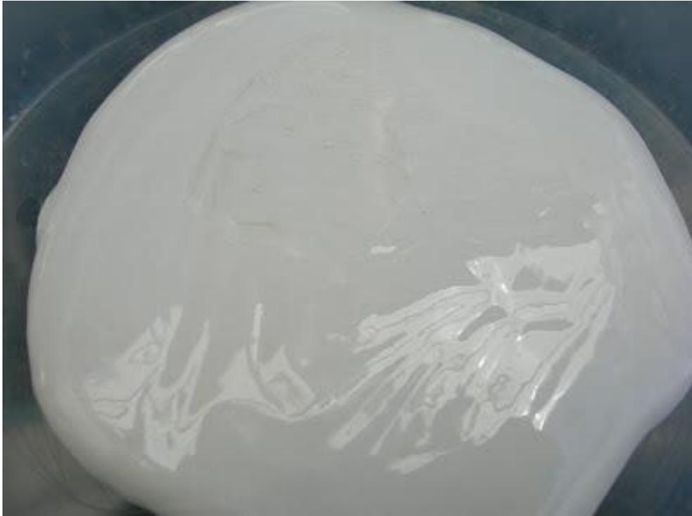
Le gel-coat a été appliqué au pinceau, j'ai remis une bande d'adhésif par-dessous et qui remonte pour former une rigole. Ça permet de bien retrouver la forme, on colle en remontant et en prenant comme référence le bord de la coque. Aidez vous d'un couteau à enduire, quand c'est une surface plane vous laissez à l'air libre.
