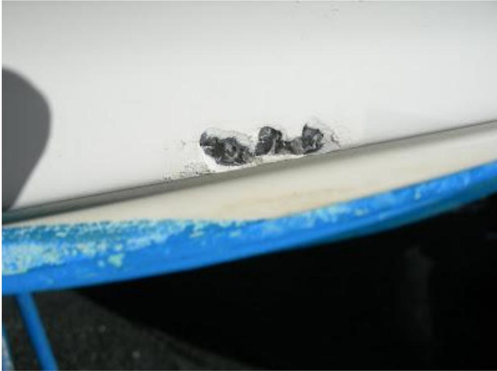
Il va falloir déjà poncer tout le pourtour de l'éclat de gel-coat en biseau. Ça permet une meilleure accroche et au niveau du ponçage une meilleure fusion du nouveau gel-coat. Vous risquez si vous ne faites pas ça d'avoir un trait qui apparaisse, au niveau de la jonction.
