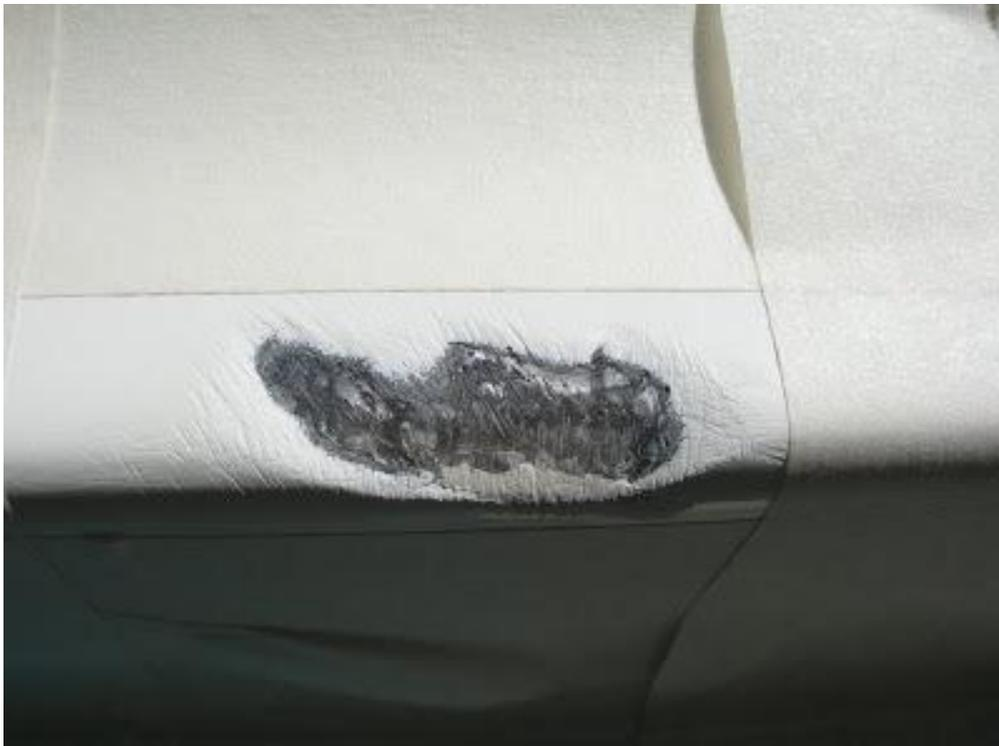
Préparation du gel-coat dans un récipient (prenez du gel-coat de finition), vous mettez 2 à 3 % de catalyseur (durcisseur) et vous mélangez. Le plus gros problème dans ce style de
