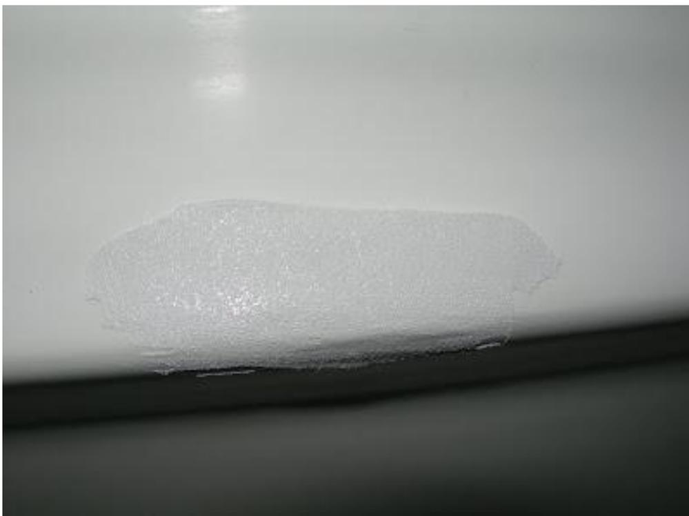
On commence à poncer avec un grain de 240, on utilise toujours une cale à poncer. Ne jamais poncer en tenant le papier avec les doigts, on verrait à coup sur des déformations créer par l'arrondi de vos doigts. S'il y a une grande surface de ponçage, vous pouvez utiliser une ponceuse orbitale.
