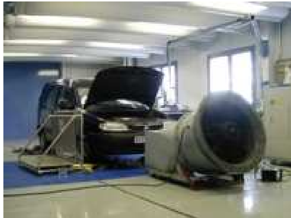
FIG. 1.4: Banc à rouleaux homologation avec le système de soufflerie (source UTAC)
