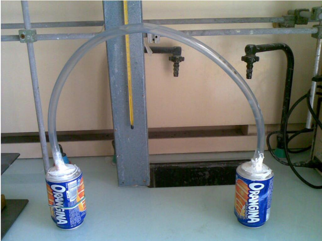
Les deux canettes sont placées au même niveau, la canette isolée du rayonnement est positionnée sur une balance afin de mesurer l'évolution de la masse d'eau.
